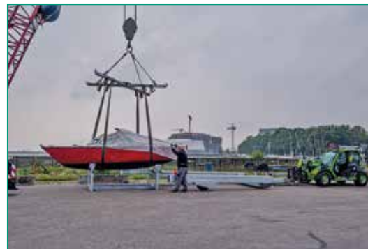
Her er de tre 'komponenter', som udstyret består af: Stativ til båden, trolley til at køre båden fra vand til vinterplads (eller modsat om foråret) og den lille traktor.
