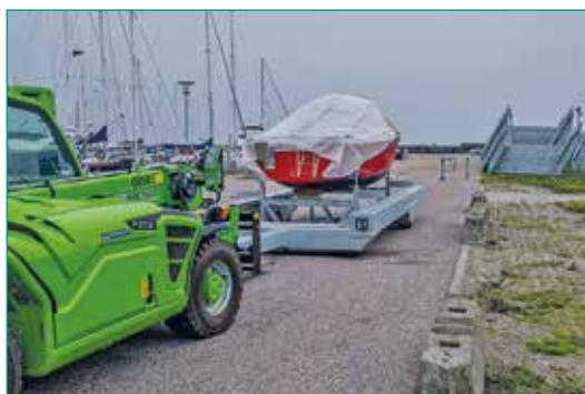
Trolleyen hæves, så stativet løftes fra jorden. Sejlåde kan beholde masten på under transporten; det kræver dog, at terrænet fra vandet til eksempelvis vinterpladsen er plant.
