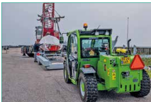
HERFRA ENMANDSBETJENT: Trolleyen stikkes ind under båden i stativet. Trolleyen passer til alle stativstørrelser. Trolleyen er hydraulisk og løfter båd og stativ op i 'kørehøjde'.
