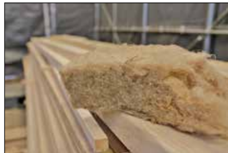
Alle byggematerialer kan enten genbruges eller komposteres. Eksempelvis er isoleringen lavet af hør. Foto: KAB.
