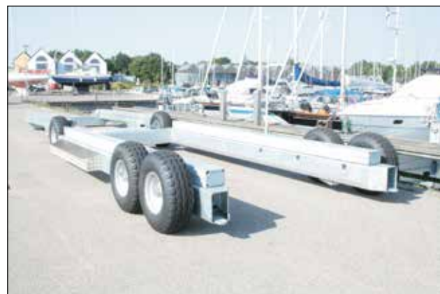
Det er slut med at bådene skal hænge i stropper på en mobilkran, når de er løftet af vandet og skal til vinteropbevaring. Nu sættes et passende stativ på denne trolley og stativ og skib køres i jordhøjde på plads.
