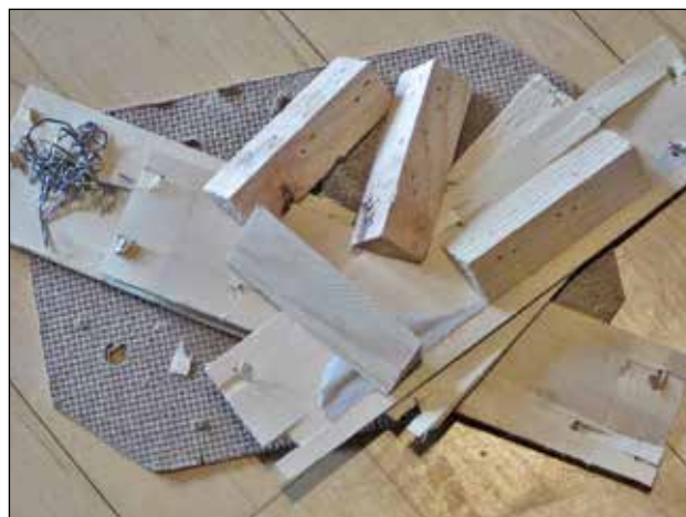
En dissikeret frugtkasse til en bakke clementiner eller mandariner indeholder 13 gram metal, 158 gram træ og 85 gram masonit.
