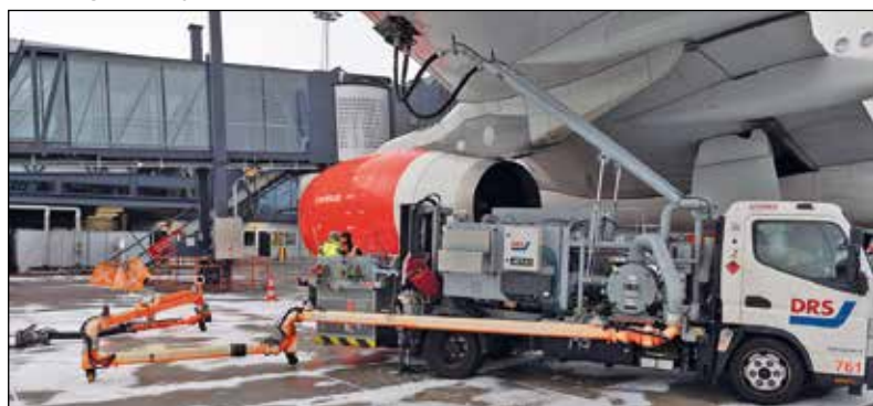
I dag tankes de fleste fly fra en pipeline direkte på standpladsen. Via dispensør-køretøjet forsyner fuel-manageren (iført gul vest ved flymotoren) flyet med flybrændstof fra lufthavnens tankanlæg
