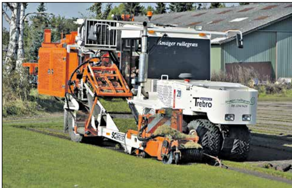
Den avancerede skæremaskine både skærer, transporterer, ruller og pallestabler græsset, ligesom de fyldte paller automatisk sættes af på marken.
