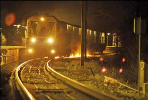
Hvis nætterne bliver mørke nok fra 1. til 6. juni venter dette syn, når fræsetogets tyske eksperter sætter fræsehjulet til skinnerne for at fjerne revner i skinnerne, fræses der omkring en millimeter af skinnen.
